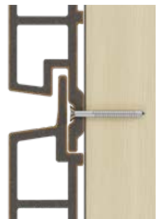
Schroef buiten zicht
